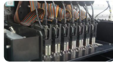
工業級壓電式噴頭，擁有超長的使用壽命以及高速打印能力。
