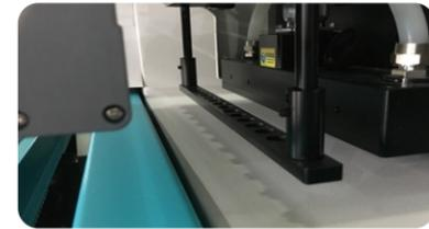
新一代防撞系統有效對應打印過程中突發事件而對噴頭造成物理損傷。
