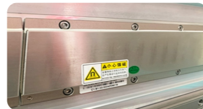
磁懸浮直排電機，X軸運行更加平穩(選配)
